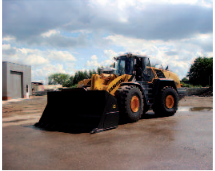
Ekkelenkamp "De lader van de voorraadbunker van de breker speelt een cruciale rol in de kwaliteitsbewaking. Deze man is ook voorzien van een nieuwe Liebherr 586 met een laadbak van ca 6,5 m 3 ."
